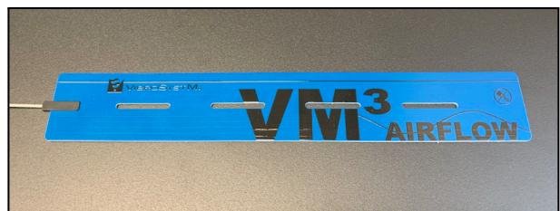
Cada cadena de medición del entrehierro VM3 AIRFLOW se compone de un sensor capacitivo pasivo sin contacto que mide la distancia entre su superficie y un objetivo metálico. La señal en bruto captada por el sensor se envía a un acondicionador a través de un cable de extensión triaxial para convertirla en una señal linealizada de 4 a 20 mA.
