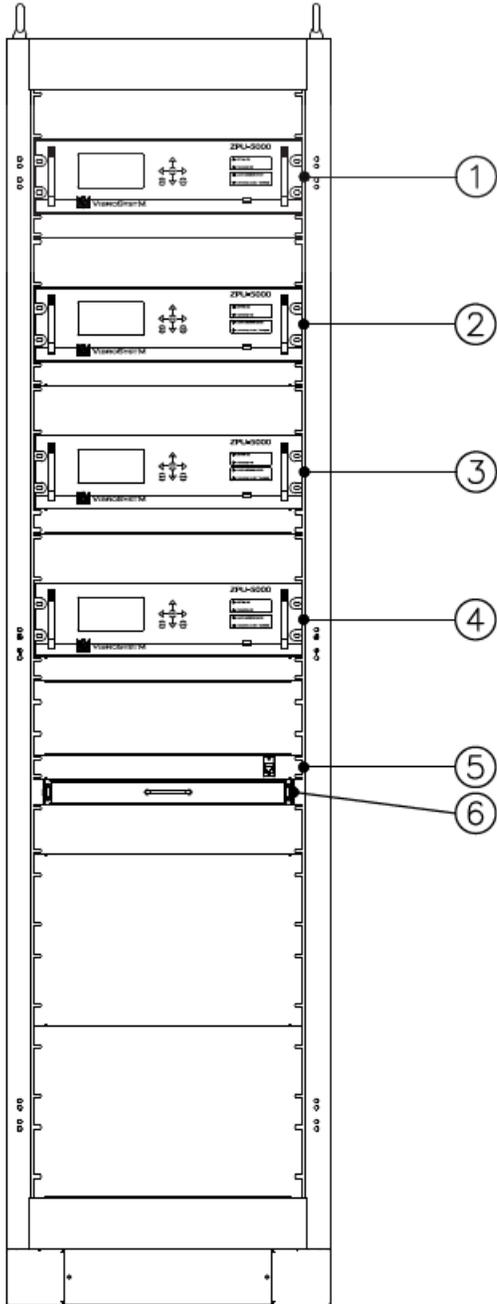
La parte frontal del armario proporciona acceso a los instrumentos y permite la conexión de una computadora portátil. Una puerta con cerradura (no mostrada) dotada con una ventana de altura completa que protege los componentes contra el polvo y el acceso no autorizado, pero permite observar las pantallas de los instrumentos.
