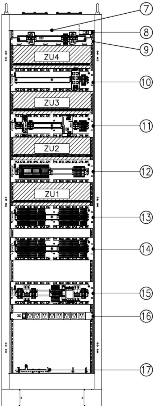
7 Cada armario incluye componentes estándar instalados directamente en el armario o agrupados en paneles, con interconexiones proporcionadas por medio de cables y arneses de cables estandarizados.
