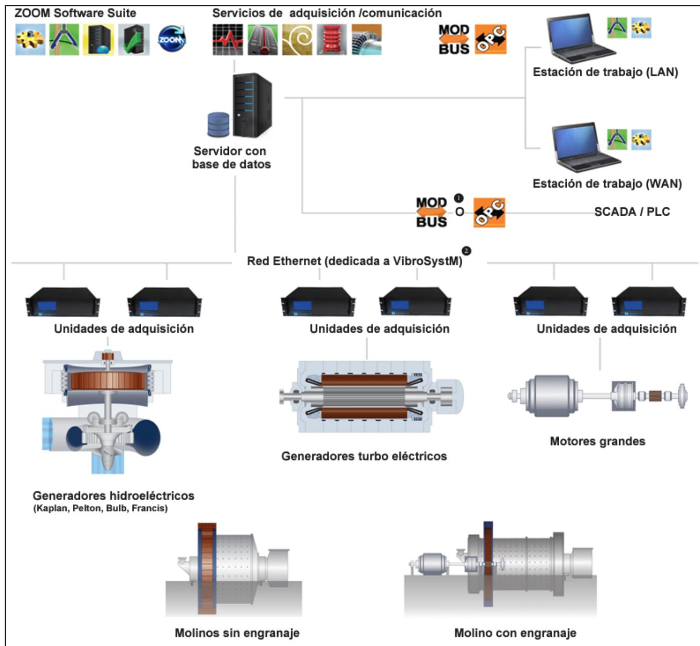
❶ Las tendencias se comparten entre el servidor y ZPU-5000 por medio de los protocolos de comunicación Modbus y OPC.
