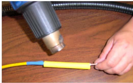
S261104F Figura 18: Inserción de la conexión SMA dentro del tubo de protección
