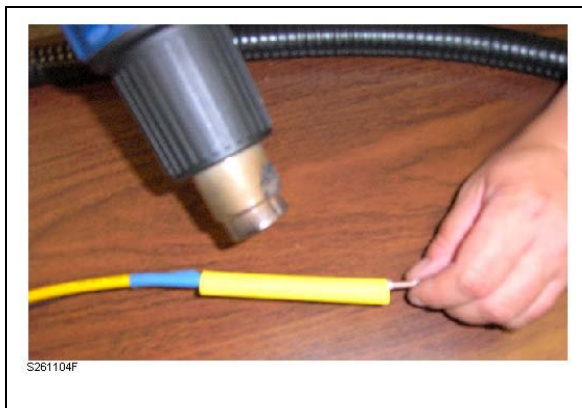
Figura 17: Calentamiento del tubo termorretráctil.
