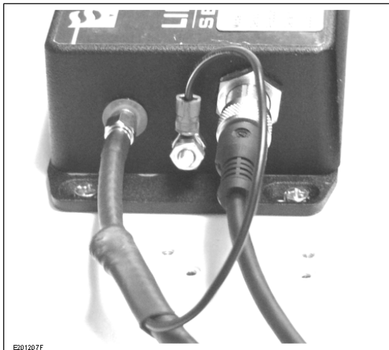
Figura 58: Cable de de entrada de alimentación y salida de señal (derecha) conectado al módulo Serie LIN-300.
