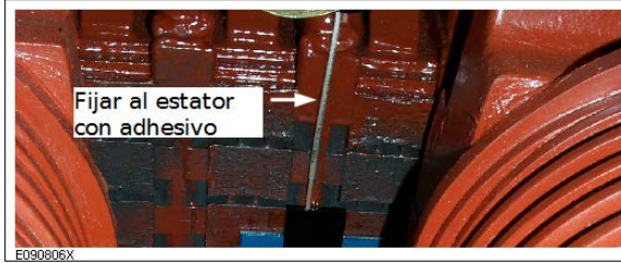
Figura 19: Fijación del cable integral al estator.
