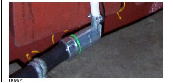
Figura 26: Conducto flexible conectado al ensamble del codo.
