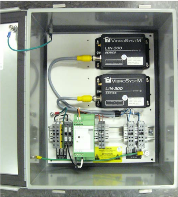
Figura 59: Módulos de acondicionadores de señal Serie LIN-300 dentro de una caja de protección con fuente opcional de alimentación.
