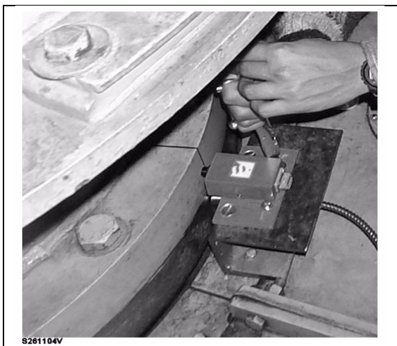
Figura 79: Ajuste final de la sonda de sincronización.
