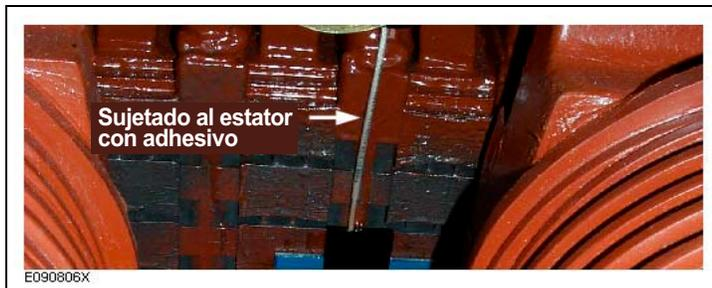
Figura 15 : Fijando el cable integral al estator
