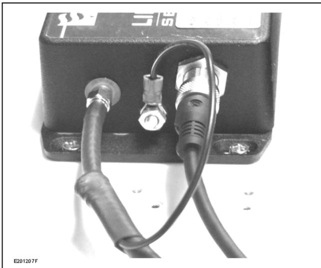
1. Introduzca el conector M12 y engránelo al girar en el sentido de las manecillas del reloj hasta que se asiente completamente.
