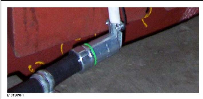
Figura 21 : Conducto flexible sujeto al conjuntos del codo
