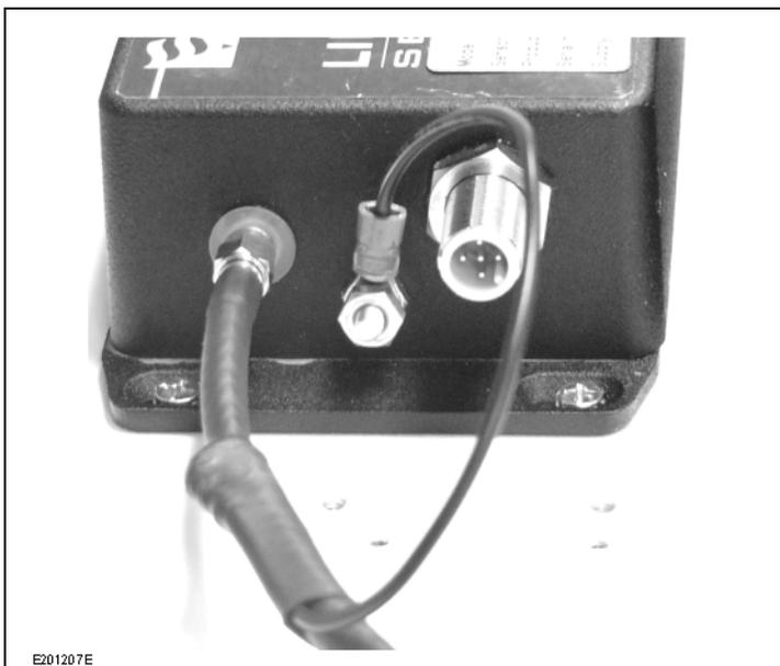
1. Introduzca el conector macho SMA y engránelo al girar en el sentido de las manecillas del reloj.
