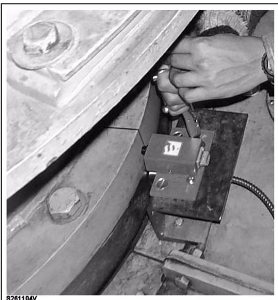
Figura 61 : Ajuste final de la sonda de sincronización
