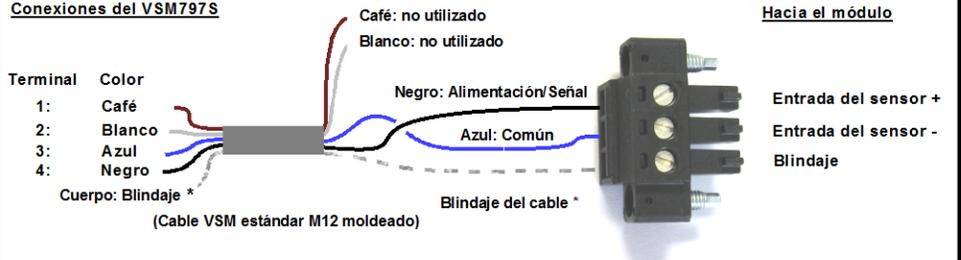
**Nota \*:** En una instalación estándar, el cuerpo del sensor está en contacto con la tierra física. Para evitar problemas de bucles a tierra, **no conecte el blindaje al conector de 3 terminales.** Sin embargo, si el cuerpo del sensor está aislado de la tierra física, conecte el blindaje del cable a la terminal correspondiente del conector de 3 terminales.
