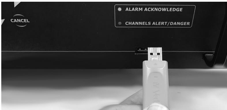
5. Introduzca la llave USB en el puerto USB dedicado de la unidad de adquisición en la que se debe aplicar el firmware actualizado. El LED **System OK** en el panel frontal de la unidad de adquisición parpadeará en amarillo mientras se copia el firmware.
