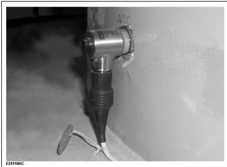
3. Le capteur est maintenu en place jusqu'à ce que la colle ait séché. Le capteur peut être installé à la verticale ou à l'horizontale.
