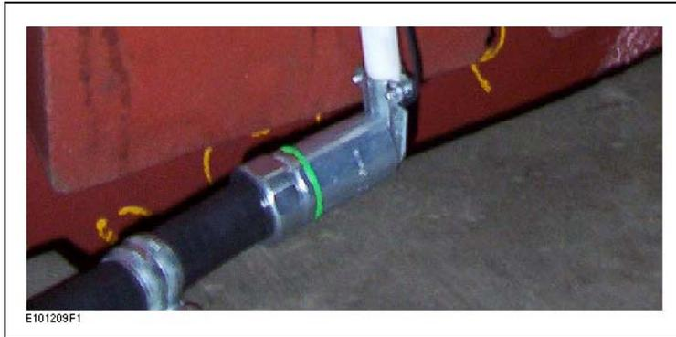
Figure 19 : Conduit flexible rattaché à l'assemblage en coude
