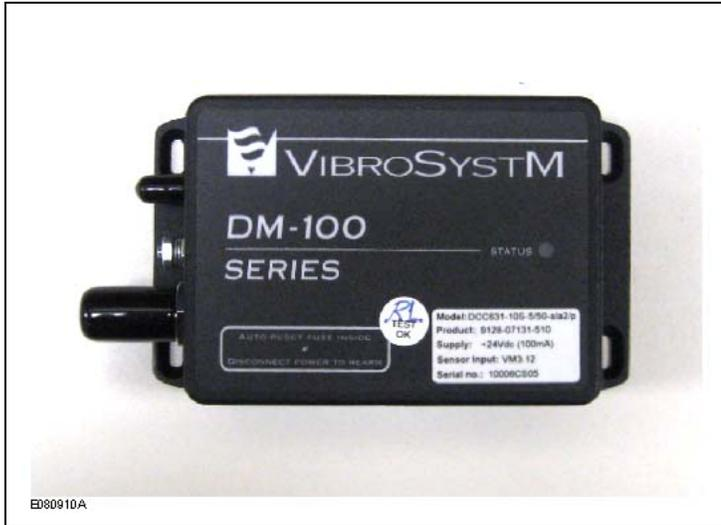
Figure 21 : Format sous lequel se présentent les conditionneurs DCC-631
