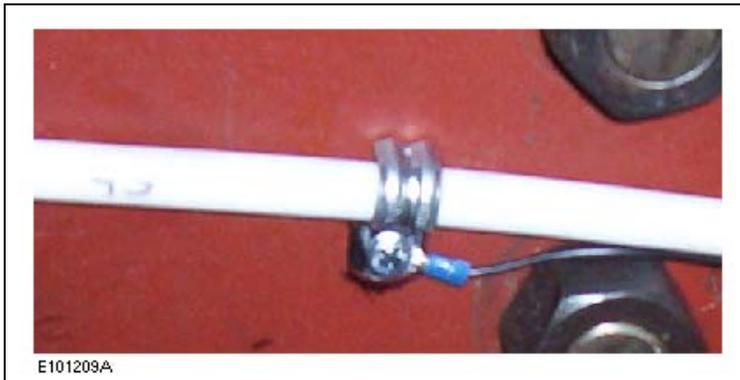
Figure 14 : Cosse de mise à la terre rattachée par le boulon d'une bride de fixation
