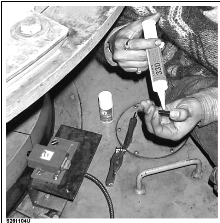
Figure 46 : Application de colle sur la cible
