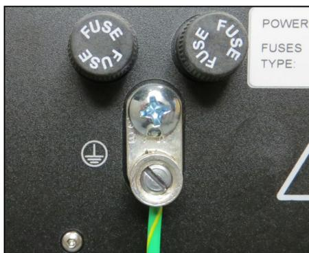
Le conducteur de mise à la terre doit être raccordé à la masse conformément à la réglementation locale. La mise à la terre est indispensable pour assurer la sécurité des personnes et la protection des équipements. Elle sert également à minimiser les effets des interférences électromagnétiques et des décharges électrostatiques.
